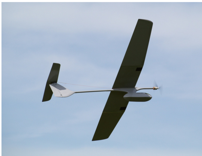
Rys. 6. Prototyp samolotu bezzałogowego klasy mini oblatany w WAT w roku 2008
