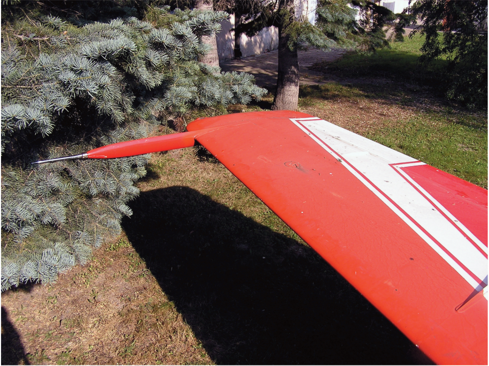
Rys. 6. Wyważenie masowe samolotu TS-11 Iskra.
