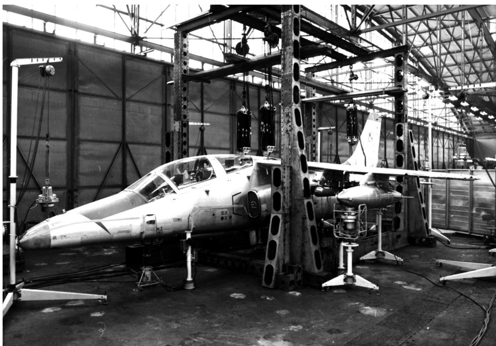
Rys. 2. Próby rezonansowe samolotu I-22 Iryda
