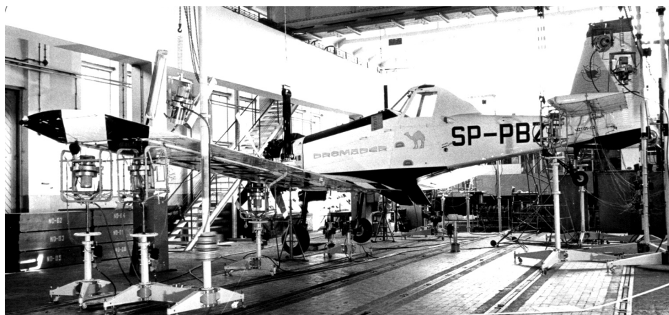
Rys. 2. Samolot M-18 Dromader podczas prób rezonansowych.
