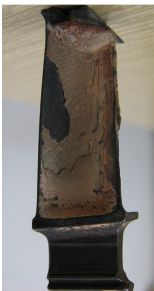
Rys. 10. Łopatka turbiny z przylegającym spieczonym pyłem
