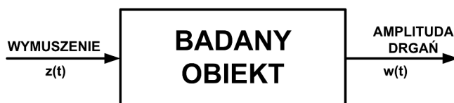
Rys. 5. Schematyczny model opisu dynamicznego maszyny
