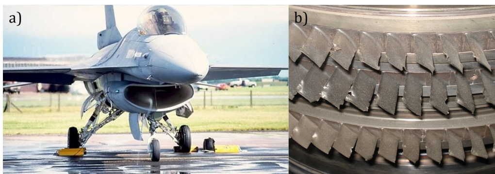
Rys. 1. Wir wlotowy powstały na wlocie do silnika samolotu F-16 (a), uszkodzona sprężarka silnika turbinowego w wyniku zassania ciała obcych przez układ wlotowy silnika (b)
