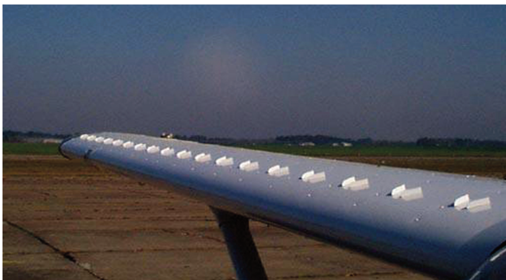
Rys. 6. Kontrrotacyjne skrzydełkowe generatory wirów umieszczone na skrzydle samolotu Cessna [32]
