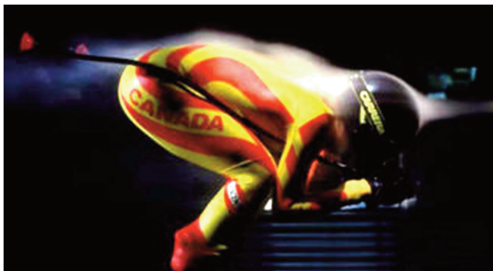
Rys. 11. Wizualizacja dymowa narciarza z generatorami wirów umieszczonymi na kasku [35]
