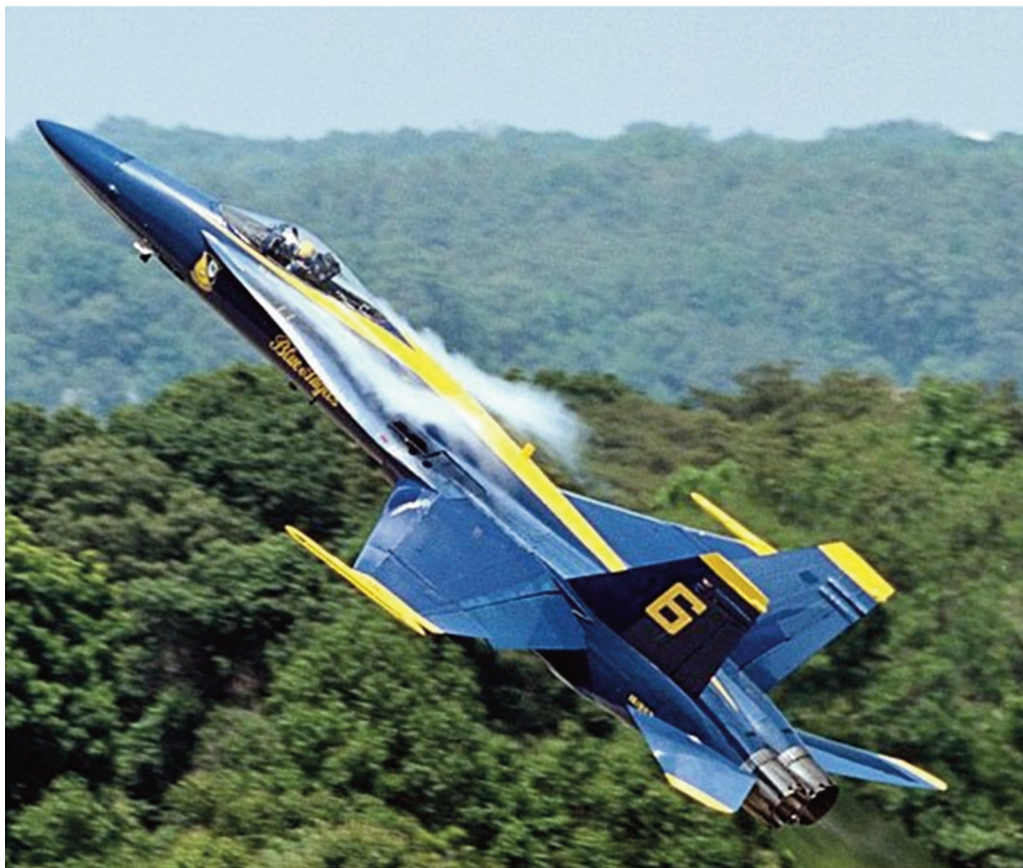
Rys. 7. Wiry tworzące się na pasmach samolotu FA-18 na dużych kątach natarcia [34]
