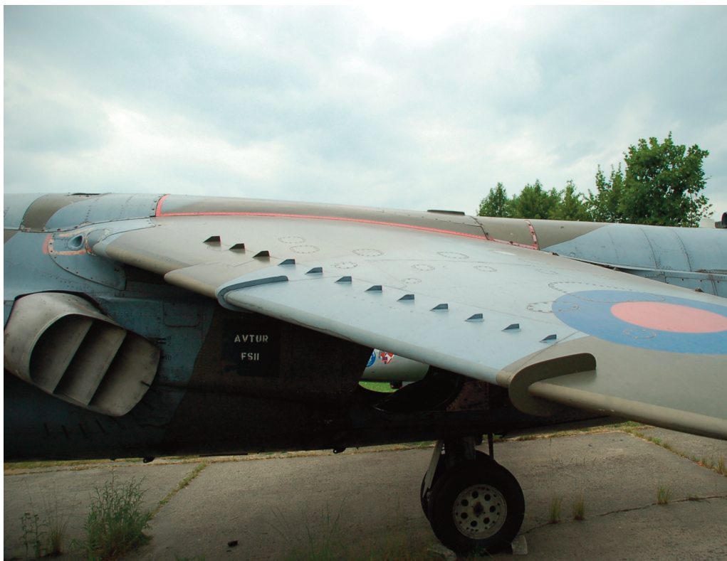
Rys. 5. Współrotacyjne skrzydełkowe generatory wirów umieszczone na skrzydle samolotu Harrier (fot. A. Dziubiński)
