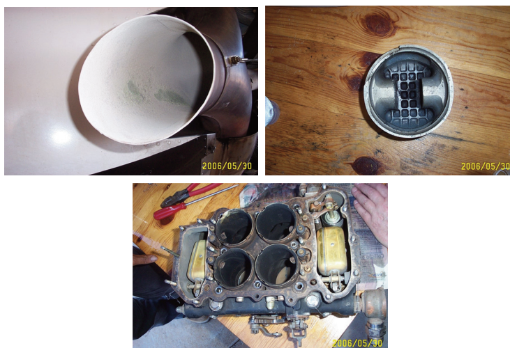
Fot. 2. B. dobry stan silnika po pracy na etanolu przy przedłużonym czasie pracy (z lewej charakterystyczny nalot w rurze wydechowej – metanamina)
