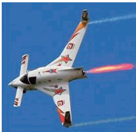
Fot. 3. Samolot raketowy na etanol źródło: Aerospace Testing International
