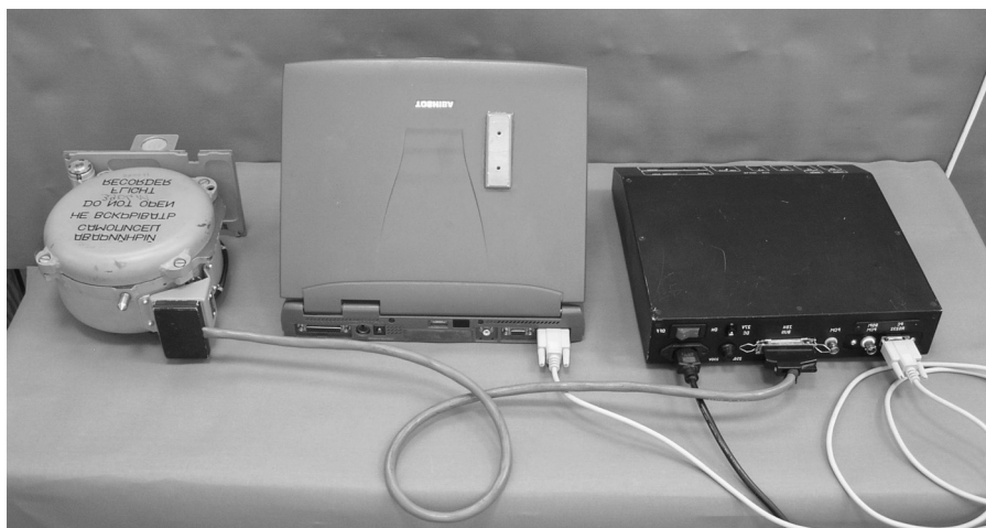
Rys. 11. System Black Box – widok połączeń czytnika z kasetą oraz komputerem
