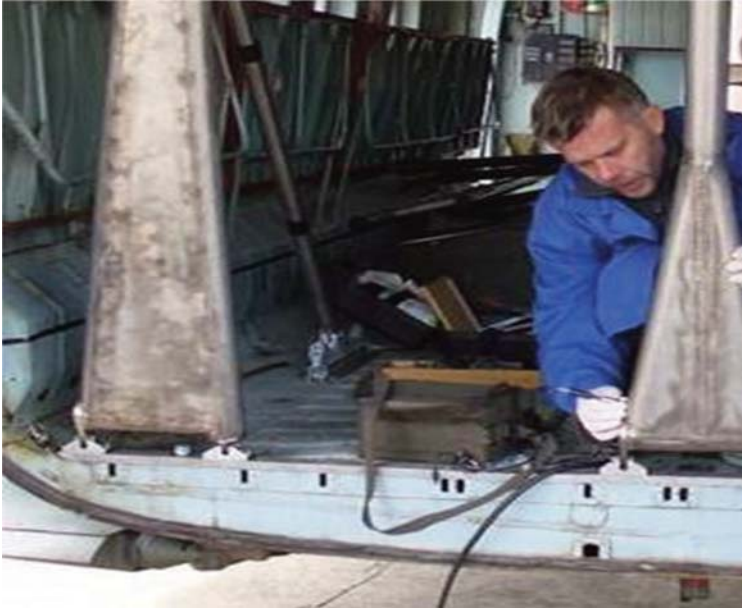
Rys. 8. Badania metodą prądów wirowych stanowiska desantowego śmigłowca
