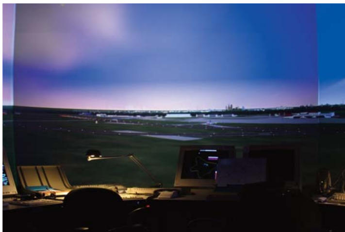
Fot. 2. Symulator z wizualizacją sferyczną (źródło: M. Gwardiak, Symulatory w szkoleniu lotniczym, materiały z sympozjum)
