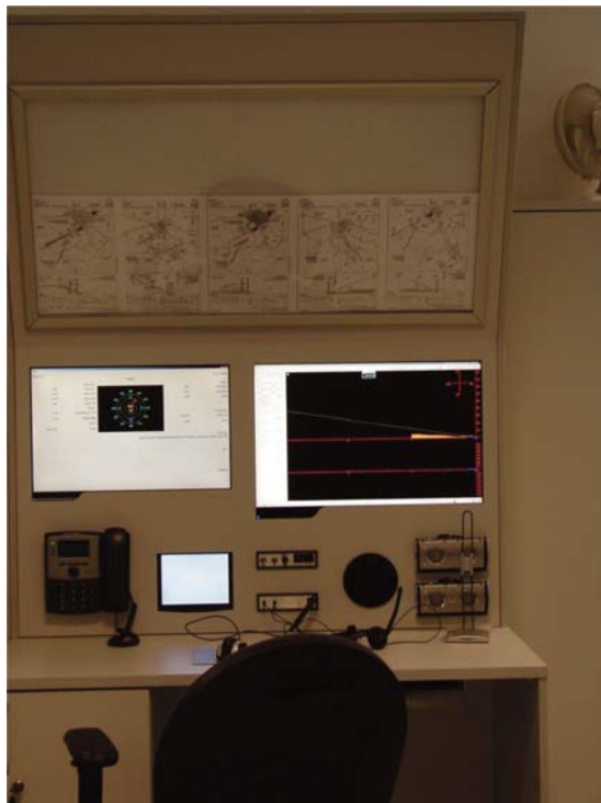
Fot. 8. Stanowisko kontrolera precyzyjnego podejścia: z prawej strony widoczny wskaźnik radaru GCA 200, z lewej wskaźnik informacji pogodowej (fot. T. Compa)
