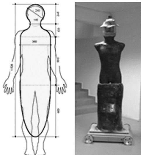
Rys. 4. Fantom termalny, a) wymiarowanie, b) fantom umieszczony na platformie jezdnej Fig. 4. Thermal phantom, a) dimensions, b) phantom on a mobile platform
