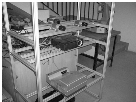
Rys. 1. Stanowisko do pomiarów fotogrametrycznych Fig. 1. Photogrammetric measurement stand
