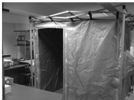
Rys. 9. Namiot elektromagnetyczny Fig. 9. Electromagnetic tent
