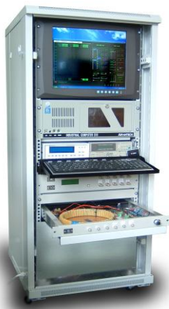
Rys. 1. System pomiarowy do badania materiałów magnetycznych Fig. 1. Measurement system for testing soft magnetic materials
