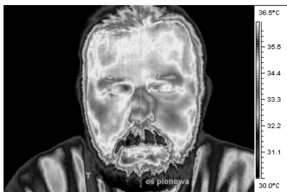
Rys. 8. Testowy termogram z zaznaczonymi obszarami twarzy (T) oraz oczu (O1, O2)
