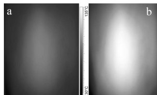
Rys. 4. Obraz termowizyjny kartki papieru nagrzewany promieniowaniem podczerwonym emitowanym przez rozgrzany drut umieszczony pionowo dla odległości: a) 10 cm ( T_{max}=93\text{ °C} ), b) 5 cm ( T_{max}=132\text{ °C} )
