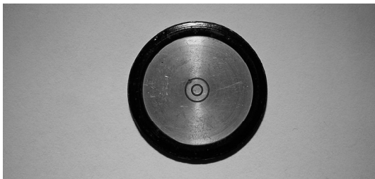
Rys. 3. Struktura tyrystora T00-80 z centralną bramką wzmacniającą
