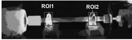
Rys. 4. Przykład obrazu termowizyjnego obserwowanej maszyny z zaznaczonymi obszarami zainteresowania (ROI)
