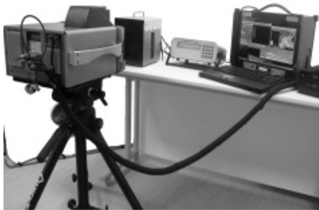
Rys. 8. Stanowisko do pomiaru emisyjności wzorca promieniowania
