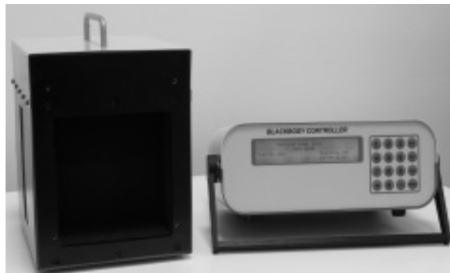
Rys. 2. Wzorec promieniowania podczerwieni typ BB-4-T Fig. 2. The picture of blackbody BB-4-T
