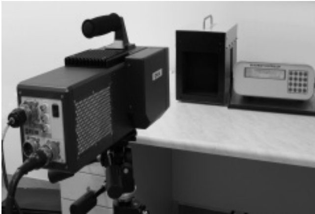
Rys. 3. Stanowisko do pomiaru stabilności krótko i długookresowej oraz jednorodności rozkładu temperatury wzorca promieniowania podczerwieni Fig. 3. The setup for measuring the stability and uniformity of the blackbody
