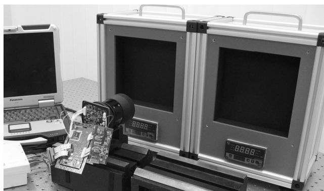
Rys. 2. Stanowisko laboratoryjne do korekcji NUC Fig. 2. Laboratory stand for NUC correction
