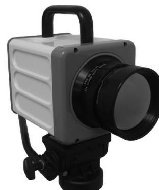
Rys. 1. Skonstruowana w Instytucie Elektroniki kamera termowizyjna Fig. 1. Thermovision camera constructed in the Institute of Electronics
