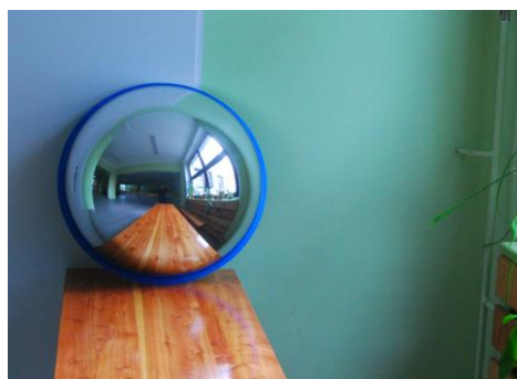
Rys. 1. Przykładowy obraz z próbnikiem oświetlenia wyposażonym w kołnierz Fig. 1. Example image of a flange-based light probe
