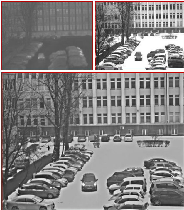
Rys. 5. Obrazy IR i TV (u góry) oraz wynik fuzji (u dołu) wykonanej przy użyciu piramidy Laplace'a
