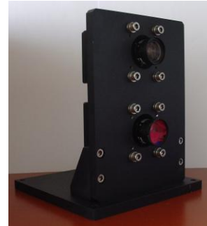
Rys. 2. Zdjęcie laboratoryjnego modelu funkcjonalnego obserwacyjnej głowicy optoelektronicznej
