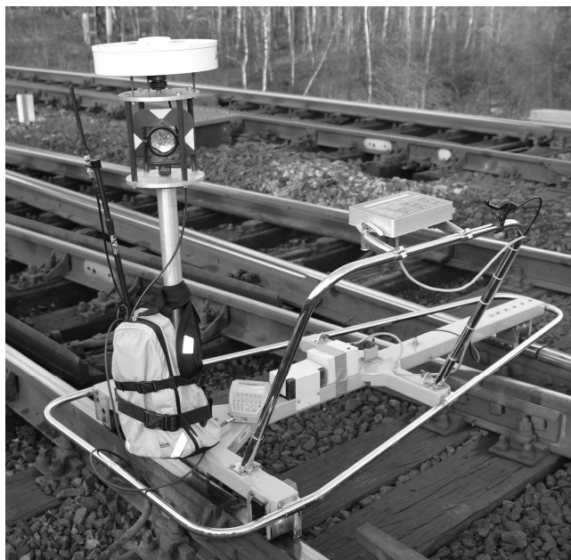
Rys. 1. Wózek pomiarowy zbudowany w AGH w Krakowie Fig.1. Track measuring trolley built at AGH in Kraków
