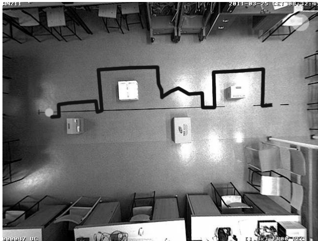
Rys. 9. Rzeczywista ścieżka ruchu robota ERSP SCORPION (scenariusz 2) Fig. 9. The real path of robot ERSP SCORPION (scenario 2)
