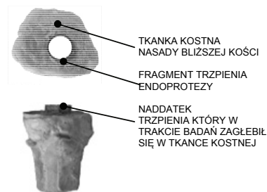
Rys. 3. Obiekt badań - badany trzpień osadzony w kości Fig. 3. Object of the experiments – the mandrel under test mounted within the bone
