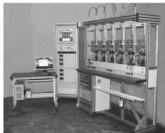
Rys. 4. Uniwersalne urządzenie do sprawdzania liczników USL SKLe-T6 [12] Fig. 4. Universal device for checking energy meters USL SKLe-T6 [12]
