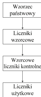
Rys. 2. Hierarchia wzorcowani liczników energii elektrycznej Fig. 2. Calibration hierarchy of electric energy meters
