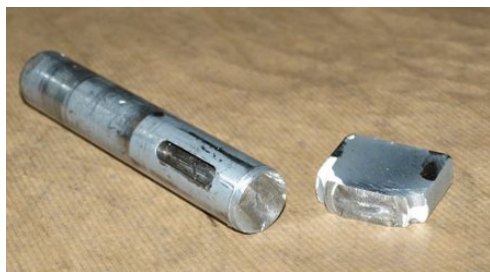
Fot. 5. Urwana pletwa ośki przeniesienia napędu do przełącznika mocy (przed awarią był to jeden element, widoczne ślady zerwania w wyniku zmęczenia materiału, aż do całkowitego ukręcenia)
