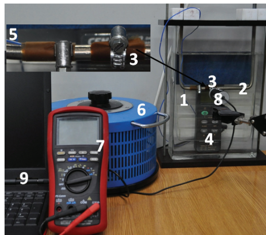
Rys. 1. Układ do badania temperatury inicjacji bubble effect w zależności od szybkości wzrostu temperatury
