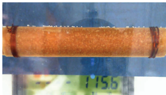
Rys. 2. Olej mineralny – papier 5% wody; 115,6 °C; start 92,2 °C
