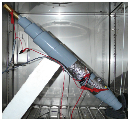
Rys. 1. Rdzeń przepustu RBP w komorze klimatycznej Fig. 1. RBP bushing core in a climatic chamber
