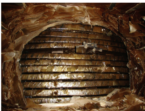
Rys. 5. Deformacja poosiowa fragmentu uzwojenia badanego transformatora
