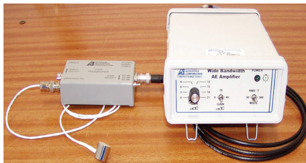
Rys. 2. Widok przetwornika pomiarowego wraz z układem wzmacniaczy Fig. 2. General view of measuring transducer with the amplifier system
