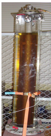
Rys. 1. Model izolatora przepustowego typu GSKTFK z izolacją papierowo – olejową
