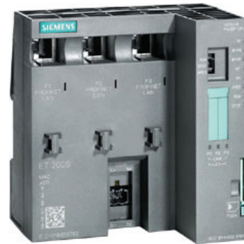
Rys. 5. Widok ogólny sterownika SIMATIC ET 200 CPU Fig. 5. Overall view of the SIMATIC ET 200 CPU controller
