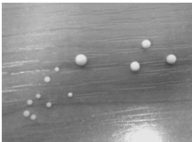
Rys. 1. Polistyren spienialny na różnych etapach produkcji Fig. 1. Expanded polystyrene for various stages of production
