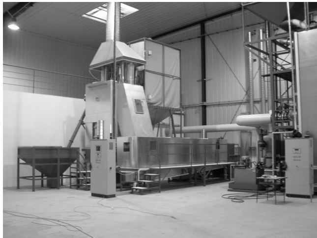
Rys. 2. Potokowy węzeł spieniający Fig. 2. Continuous pre-expander
