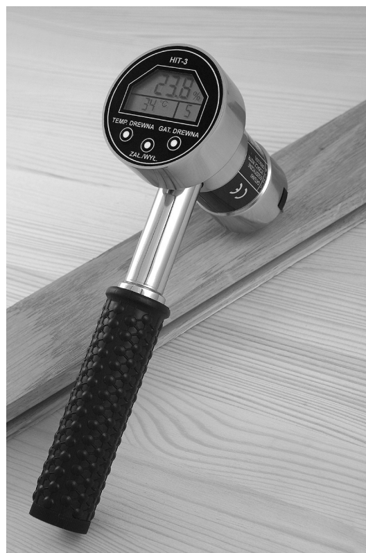
Rys. 1. Wilgotnościomierz rezystancyjny Fig. 1. Resistance-based moisture meter
