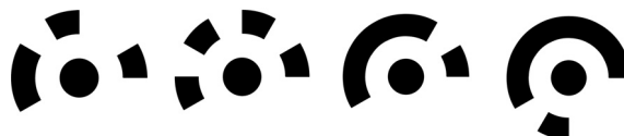
Rys. 3. Przykładowe znaczniki o kodach 2, 5, 7 i 93 Fig. 3. An example of marker with code 2, 5, 7 and 93
