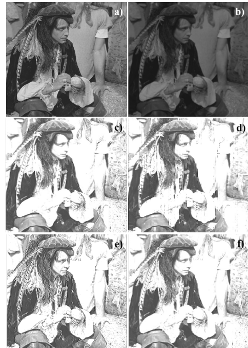
Rys. 7. Obraz a) bez szumu, b) zaszumiony rozmywającym szumem Gaussa o zerowej wartości średniej, A = 1 i \sigma = 2 , a następnie odszumiony metodą regularyzacji c) Tichonowa, d) TSVD, e) DSVd, f) ME
