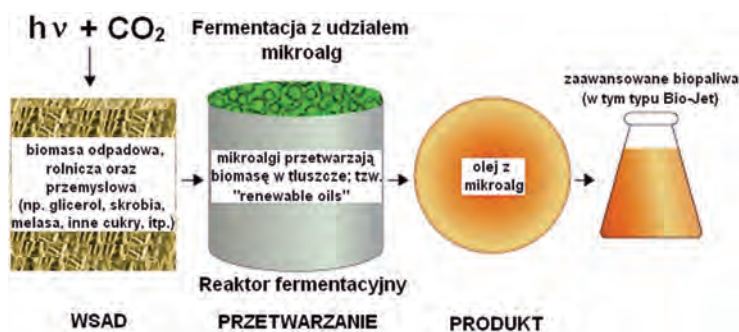
Rys. 2. Schemat procesu produkcji paliwa typu Bio-Jet opracowany przez firmę Solazyme [3]
