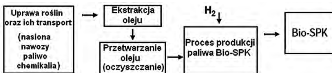
Rys. 3. Schemat cyklu produkcyjnego biopaliwa typu Bio-SPK [5]
