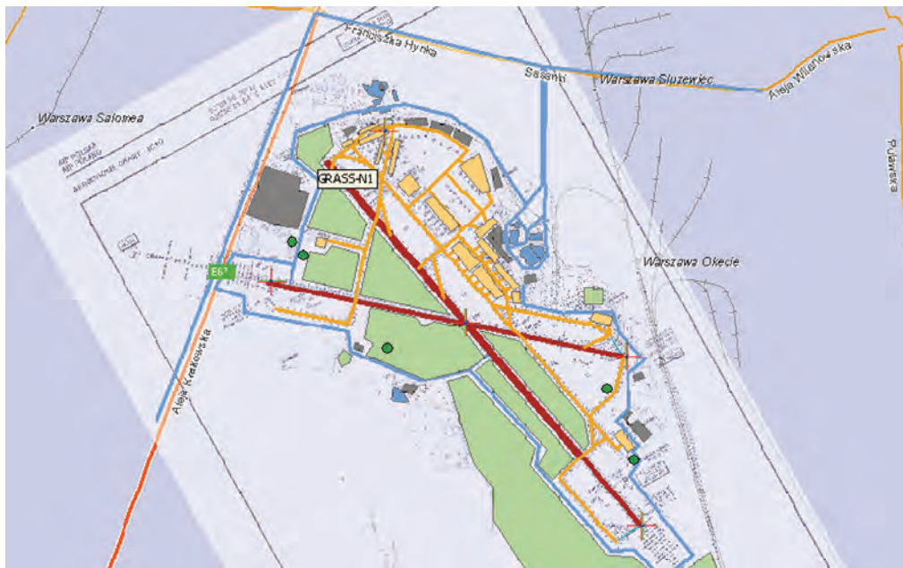
Rys. 3.1. Geograficzny model lotniska F. Chopina dla obliczeń programem ALAQS
