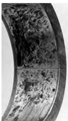
a) wewnętrzna bieżnia łożyska-fretting
