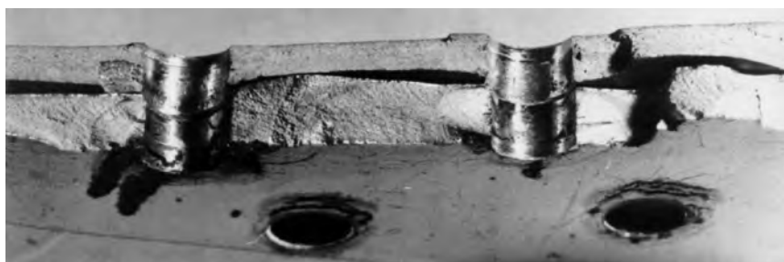
Rys. 33. Fragment przełomów półki żebra i nakładki w rejonie otworów oznaczonych na rys. 1, pow. x 0,5 [27]
