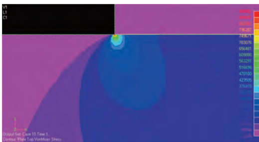
c) Naprężenia \sigma_{yy} - efekt przykrawędziowy
