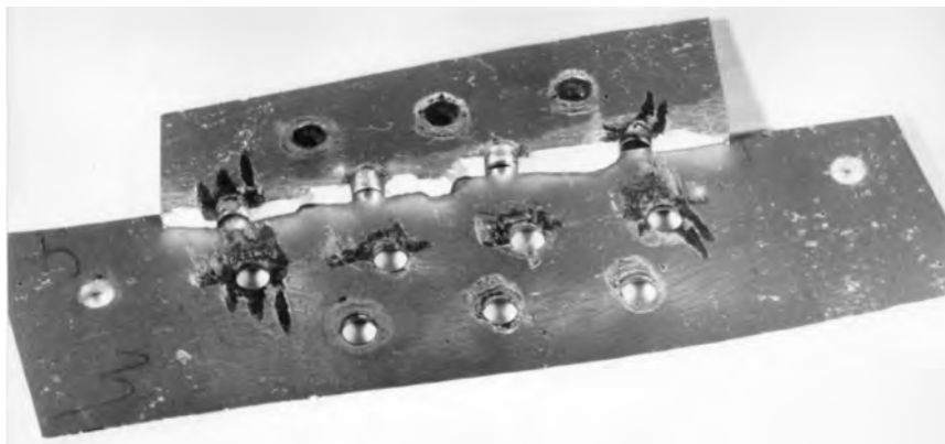
Rys. 32. Wygląd stykających się powierzchni pokrycia skrzydła i nakładki, pow. x 1,3. Ciemne plamy na obu powierzchniach powstały na skutek zmęczenia ciernego. Otwory oznaczone cyframi 1 i 2 pokazano na rys. 33 [27]
