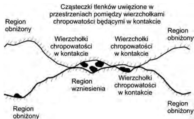
a) Kumulacja cząsteczek tlenków w przestrzeniach między wierzchołkami chropowatości
