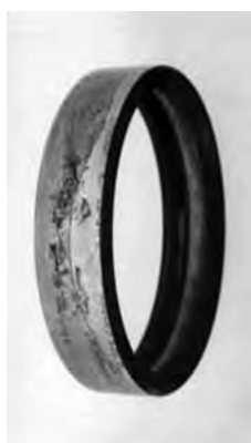
b) zewnętrzna bieżnia łożyska-fretting
