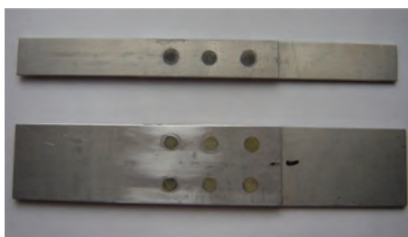
Rys. 19a. Widok dwóch próbek przed badaniem zmęczeniowym
