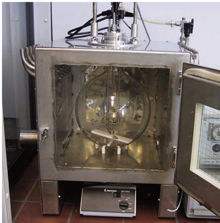
Rys. 2. Zestaw pomiarowy stosowany w metodzie ASTM E681-01 [76]
