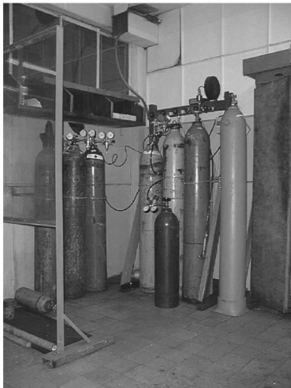
Rys. 11. Ogólny widok stanowiska do precyzyjnego przygotowywania mieszanin gazowych
