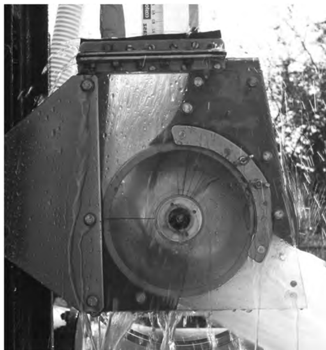
Rys. 8. Turbina wodna w czasie pracy na stanowisku badawczym
