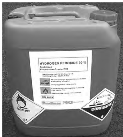
Rys. 8. Nadtlenek wodoru wysokiej czystości klasy HTP (30 kg opakowanie z HDPE) – produkt zateżenia handlowo dostępnego H_2O_2 , oferowany przez szwedzką firmę Peroxide Propulsion [13]
