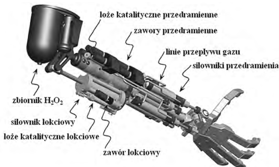
Rys. 18. Schemat protezy przedramienia napędzanej za pomocą H 2 O 2 klasy HTP [39]
