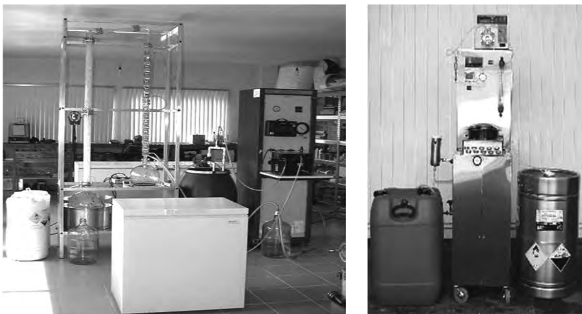
Rys. 9. Dostępne komercyjnie instalacje do zateżnienia H_2O_2 o stężeniu 30% do klasy HTP [14,17]
