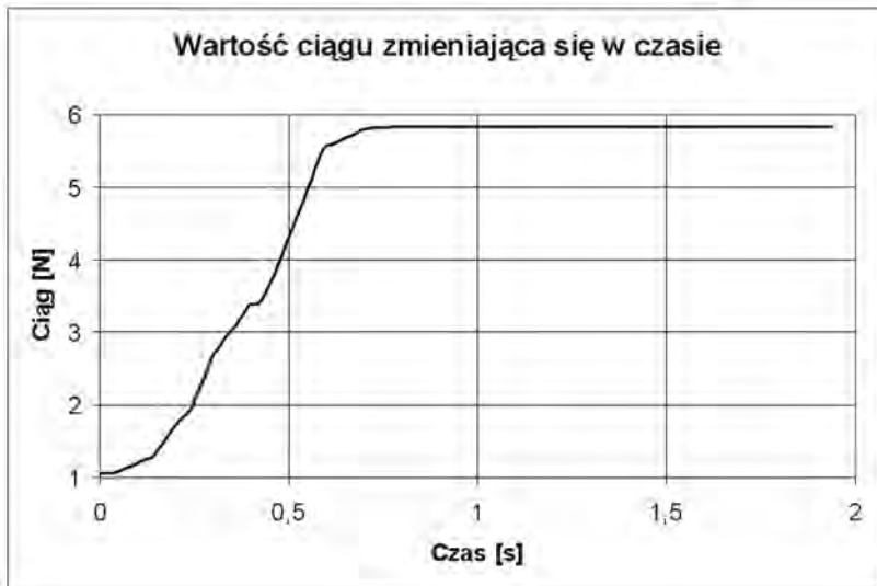
Rys. 16. Charakterystyka dynamiczna przedstawiająca wzrost ciągu silnika, wartość wypełnienia z 30% do 80% współczynnika PWM
