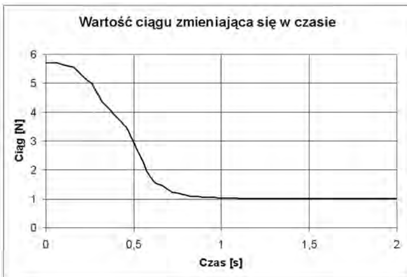
Rys. 17. Charakterystyka dynamiczna przedstawiająca malejący ciąg silnika, wartość wypełnienia z 80% do 30% współczynnika PWM
