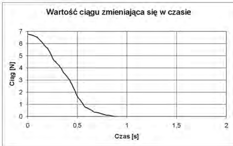
Rys. 15. Charakterystyka dynamiczna przedstawiająca malejący ciąg silnika, wartość wypełnienia ze 100% do 0% współczynnika PWM
