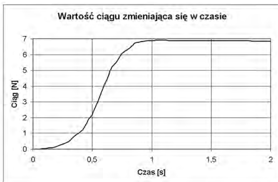
Rys. 14. Charakterystyka dynamiczna przedstawiająca wzrost ciągu silnika, wartość wypełnienia z 0 do 100% współczynnika PWM
