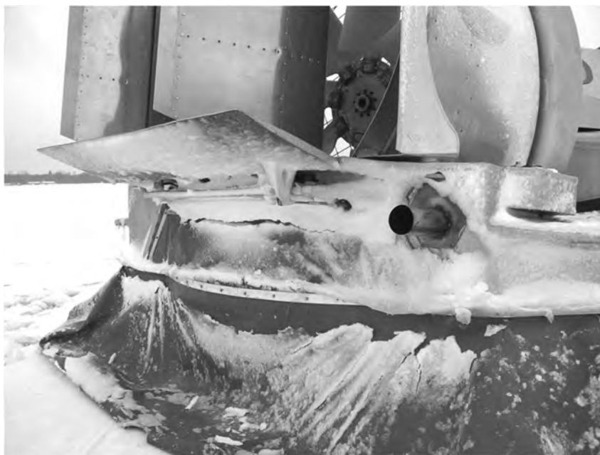
Rys. 3. System „odwracacza ciągu” na poduszkowcu PRP-C600 „Sawia” w trakcie badań
