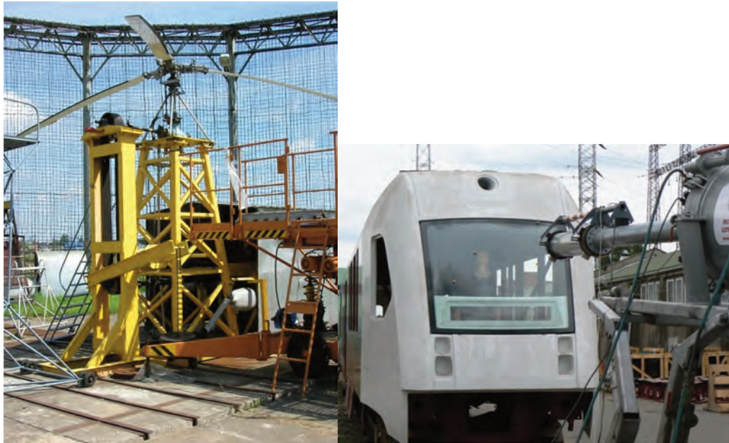
Fot. 3. Laboratorium badań wirników śmigłowców i próby szyb lokomotyw
