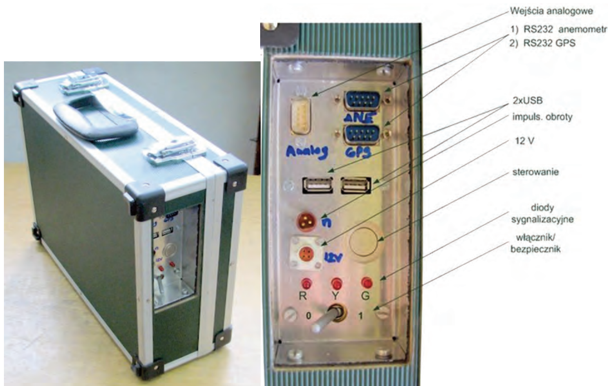
Rys. 4. Urządzenie z układem pomiarowo-rejestrującym: z lewej zewnętrzny widok walizki, z prawej zewnętrzny panel sterowania
