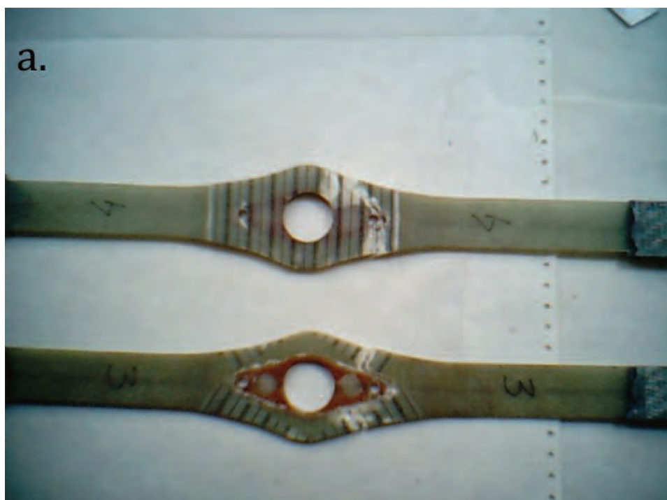
Rys. 5.a. Torsojny po badaniu, zerwane
