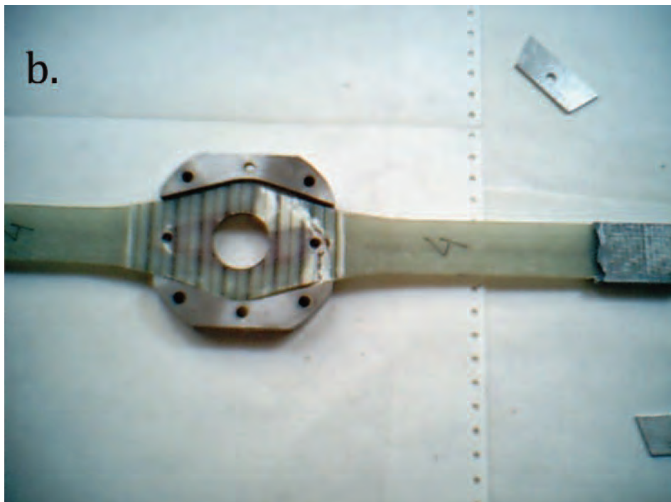
Rys. 5.b. Torsojny po badaniu, zerwane
