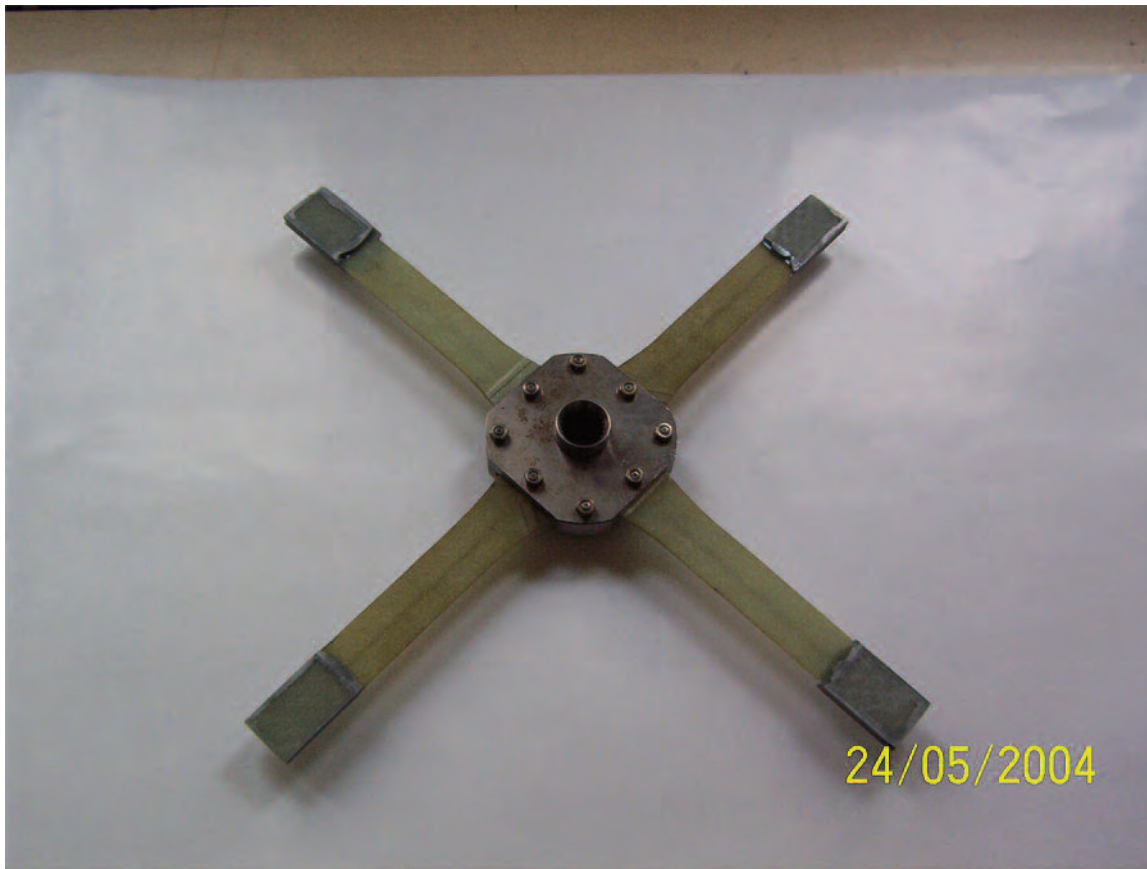
Rys. 4. Układ dwóch torsojnow przygotowany do badania
