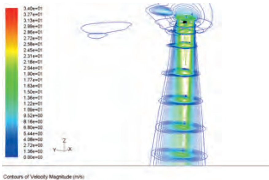
Rysunek 12. Pole prędkości i linie prądu podczas zawisu śmigłowca W-3 Sokół, FLUENT
